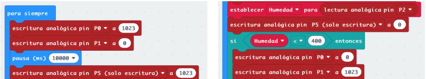
En los pines P0 y P1 hemos colocado dos leds que indican el estado del funcionamiento del proyecto. El Led conectado a P0 se encenderá a toda potencia mientras está el sistema de riego apagado y cuando vaya a regar, dejará de lucir y se encenderá el led del P1.
